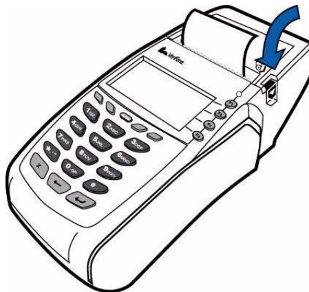
Рис. 10 Закрытие крышки рулона бумаги
